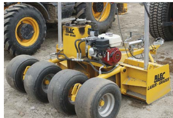
Lyöntipaikkojen pintojen tasoitukseen käytetty Blec Laser Grader -lasertasointuskone. (AS)
